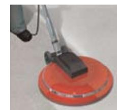
Cementne i anhidridne podlove obrusiti i očistiti industrijskim vakuumskim usisavačem. Stare keramičke ploče odmastići i očistiti. Kada se lijepi na Sika® Level-200, -300, -340, -315 F samonivelirajuće mase nije potrebno brusiti i mazati temeljni premaz.
