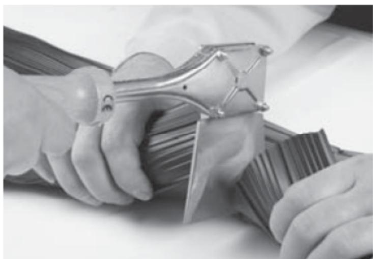
PVC treba zagrijavati bez pregorijevanja. Nakon što se rastopi 2-3 mm PVC-a, alat se polagano makne i rastopljeni krajevi brtvi se pritisnu jedan na drugi. Postupak se ponavlja duž cijelog presjeka brtve.
