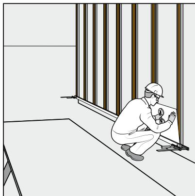
Prvo postavite panel za oblaganje u željeni položaj pazeći da ne dodiruje montažnu traku. Nakon toga čvrsto pritisnite dok ne dotakne Sikatack® Panel montažnu traku.
