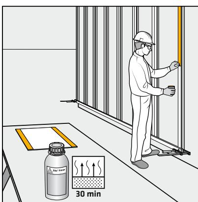
Dobro protresite SikaTack® Panel Primer (kretanje čeličnih kuglica u posudi se mora jasno čuti). Nanesite jedan tanak sloj SikaTack® Panel Primer-a ravnomjerno preko cijele površine pomoću filca.
