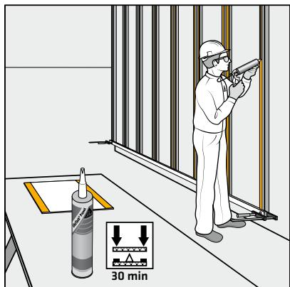
Nanelite Sikatack® Panel ljevilo pomoću isporučene trougaone mlažnice (širine 8 mm, visine 10 mm) sa najmanje 5 mm razmaka od montažne trake i od stranice lajsne.
