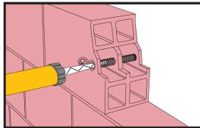
Ubrizgavati ljepilo u perforiranu tiplu, počevši od dna, polako povlačeći statički mikser. U svakom slučaju izbjegavati zarobljavanje zraka.
