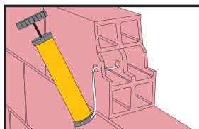
Izbušenu rupu nakon svakog koraka očistiti komprimiranim zrakom ili pumpom, počevši od dna rupe (min.1x). Važno: koristiti kompresore bez ulja.
