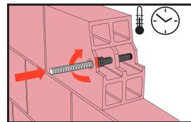
Rotacijskim pokretima umetnuti anker u ispunjenu perforiranu tiplu. Koristiti odgovarajuću veličinu čelične šipke. Važno: Anker se mora postaviti unutar otvorenog vremena.
