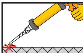
Pumpati cca. 2x dok oba dijela ne počnu izlaziti ravnomjerno. Ne koristiti ovaj materijal. Otpustiti pritisak pištolja i otvor spremnika očistiti krpom.
