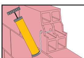
Izbušenu rupu nakon svakog koraka očistiti komprimiranim zrakom ili pumpom, počevši od dna rupe (min. 1x). Važno: koristiti kompresore bez ulja.
