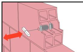
Izbušenu rupu temeljito očistiti okruglom četkom (četkati najmanje 1x). Prečnik četke mora biti veći od prečnika rupe.
