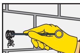
Izbušena rupa mora se temeljito očistiti posebnom čeličnom četkom (četkati najmanje 2x). Prečnik četke mora biti veći od prečnika rupe.
