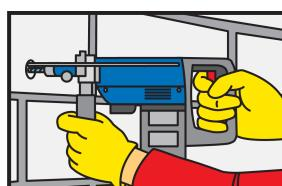
Izbušiti rupu elektičnom bušilicom do potrebnog prečnika i dubine. Prečnik rupe mora biti u skladu s veličinom ankera.
