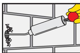
Izbušenu rupu nakon svakog koraka očistiti komprimiranim zrakom ili pumpom, od dna rupe (min. 1x). Važno: koristiti kompresore bez ulja.
