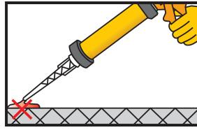
Pumpati cca. 2x dok oba dijela ne počnu izlaziti ravnomjerno. Ne koristiti ovaj materijal. Otpustite pritisak pištolja i očistite otvor spremnika krpom.
