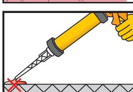
Pumpati cca. 2x dok oba dijela ne počnu izlaziti ravnomjerno. Ne koristiti ovaj materijal. Otpustiti pritisak pištolja i otvor spremnika očistiti krpom.
