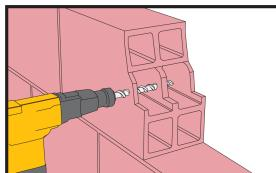
Izbušiti rupu el. bušilicom do potrebnog prečnika i dubine. Prečnik rupe mora biti u skladu s veličinom ankera i perforiranih tipli. Napomena: ne koristiti udarno rotacione bušilice sa šupljim materijalom.
