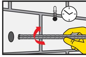
Rotacijskim pokretima umetnuti anker u ispunjeni otvor (mora izaći nešto ljepila). Važno: anker se mora postaviti unutar otvorenog vremena.
