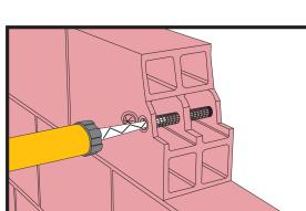
Ubrizgavati ljepilo u perforiranu tiplu, počevši od dna, polako povlačeći statički mikser. U svakom slučaju izbjegavati zarobljavanje zraka.
